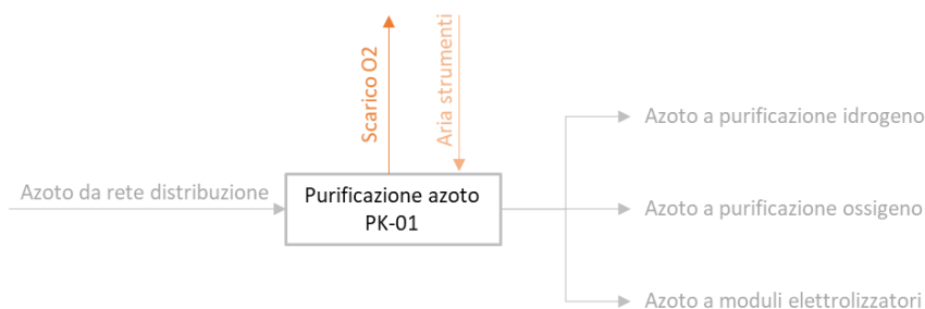
Figura 8 – Schema a blocchi del package di purificazione dell'azoto PK-01
