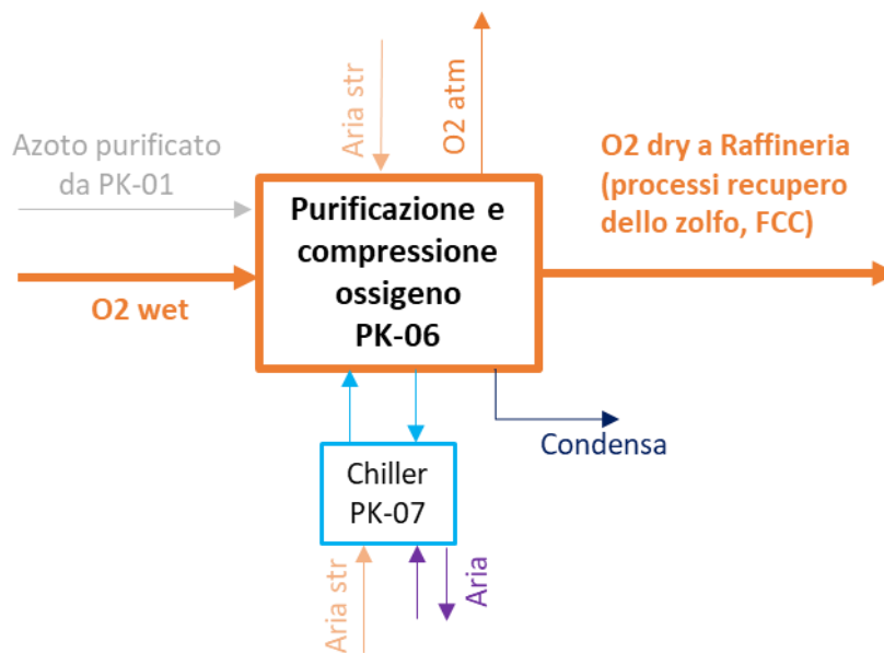
Figura 22 – Schema a blocchi del package di purificazione dell'ossigeno PK-06
