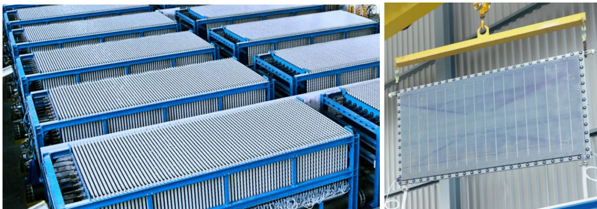
Figura 16 – Dettaglio delle celle elettrochimiche PEM
